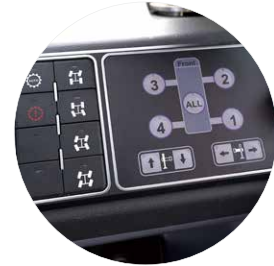
Steering control panel 转向控制面板
